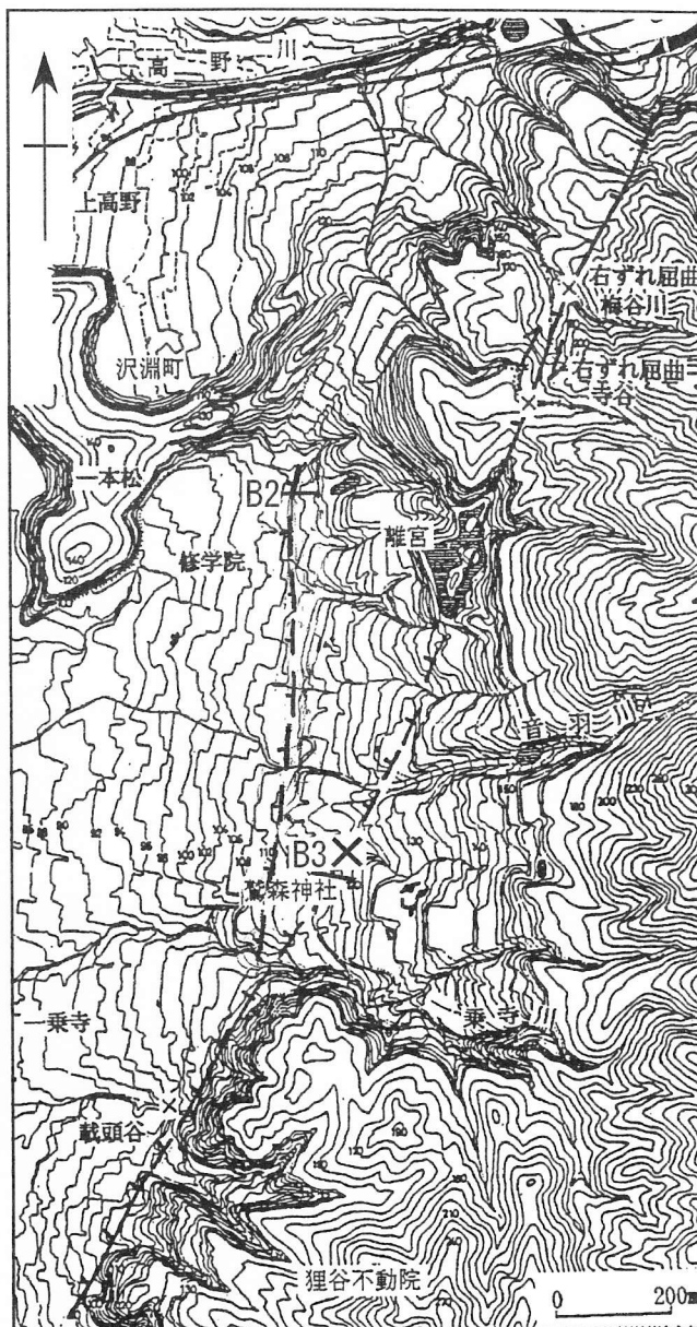
図 II-15 修学院付近における花折断層の変位地形 ×印は地質調査所によるトレンチ地点 （等高線は 2m 間隔、京都市 1996 に加筆）
